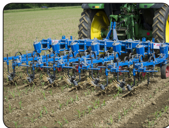
Désherbage mécanique sur maïs avec une bineuse à doigts. ©Pascal Xicluna/Min.Aagri.Fr
